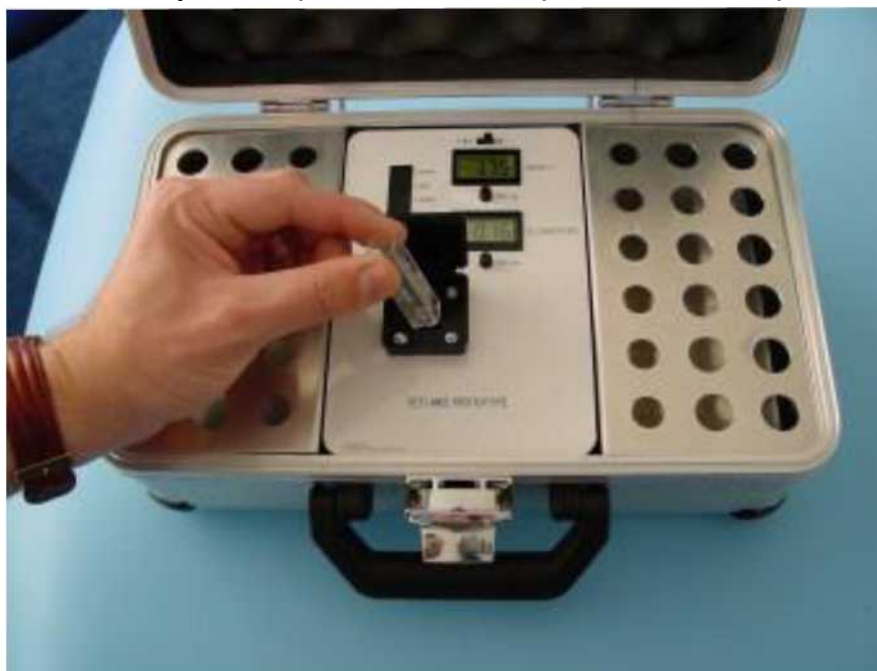
Рис. 29. Прибор GreenScreen EM для анализа генотоксичности.
